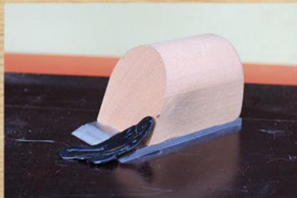
Den überschüssigen Füller mit dem Hobel entfernen.
