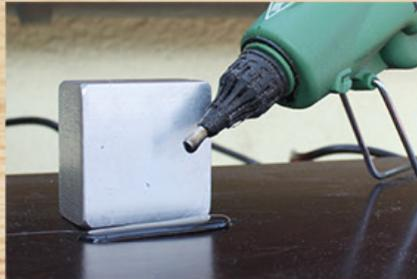
Den Füller mit der Pistole in die Reparaturstelle einbringen.
